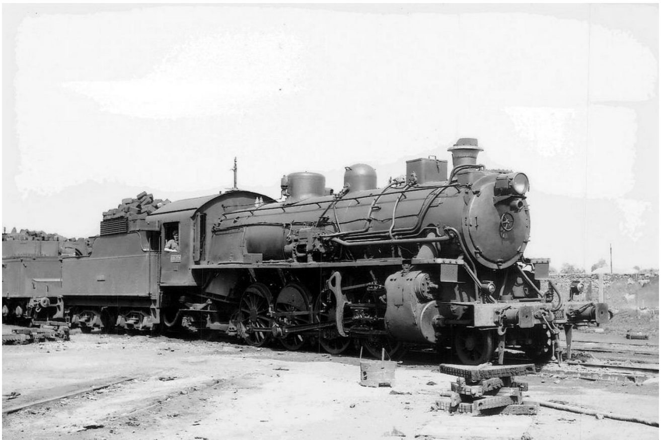
53. Renfe 141-2020, ya con la tapa de la caja de humos remodelada, en 1961.
