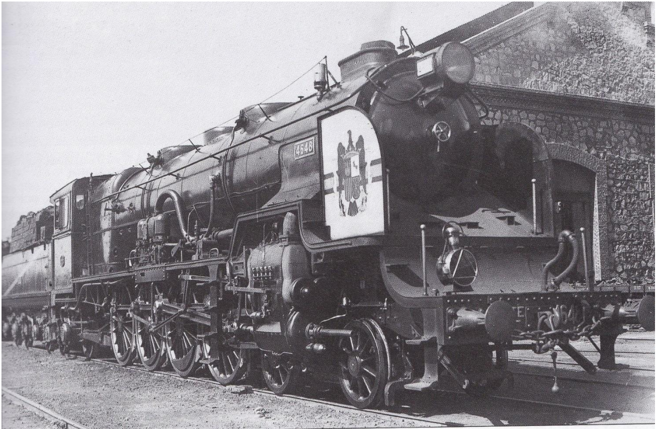
59. Norte 4648 después de ser transformada según las directrices del ingeniero francés André Chapelon.
