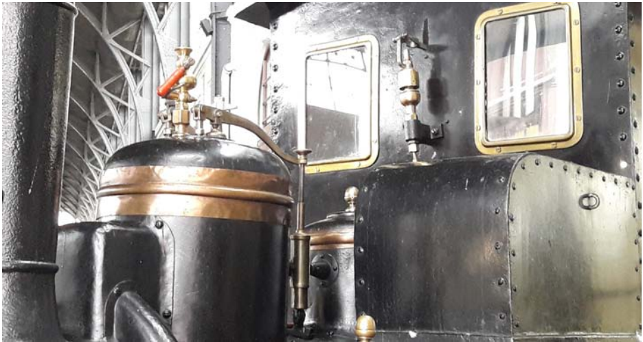
Fig. 13. Detalle de domo, válvula y silbato (JHA, 1-12-2016).
