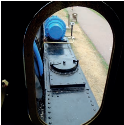
Fig. 10. Tapa de llenado de tanque lateral. Locomotora 030T "Reyerta". Una Krauss de 1913 para vía métrica, que perteneció a Nueva Montaña Quijano. Puente Viesgo, Cantabria (JHA, 19-7-2015).
