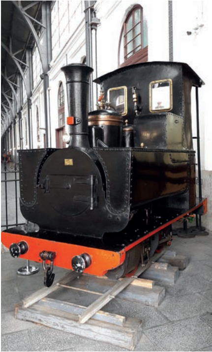
Fig. 18. Locomotora-ténder de tanques laterales. Museo de Ferrocarril de Madrid (JHA, 1-12-2016).
