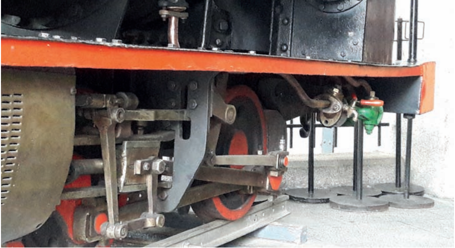
Fig. 11. Inyector de locomotora-tender 020. Una Couillet de 1882 que prestó servicio en Minas de Barruelo (vía de 550 mm). Museo de Ferrocarril de Madrid (JHA, 1-12-2016).
