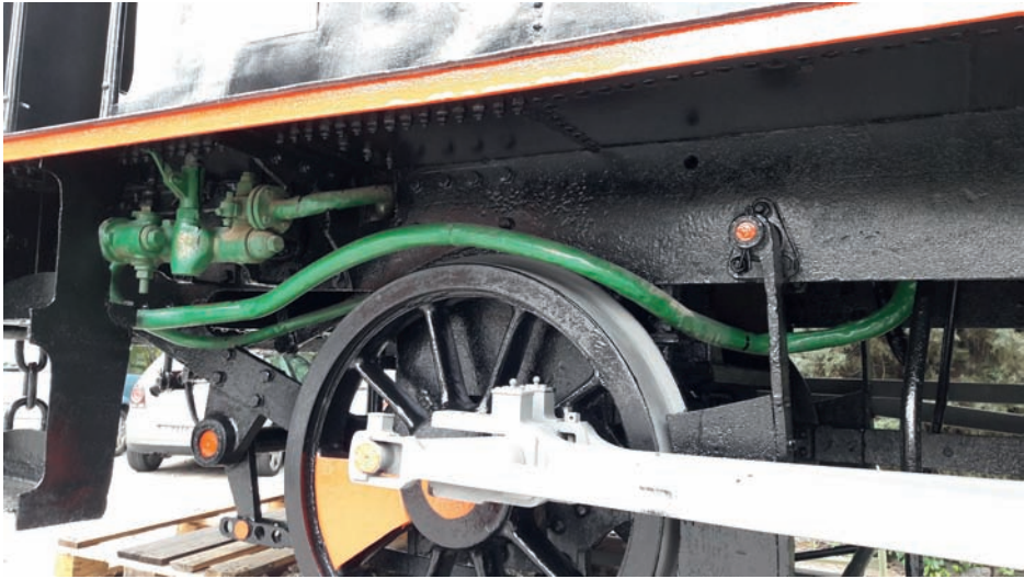
Fig. 12. Inyector y tubería de alimentación de locomotora 020-0231 de Renfe, anteriormente de MZA, fabricada en 1885 por Couillet. Museo de Ferrocarril de Madrid (JHA, 1-12-2016).
